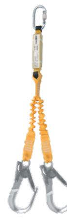
ABM-SCF BW260 amortyzator bezpieczeństwa BW 260 15 z podwójną linką o dł. 1,5 m + AZ 011 + 2 x AZ 023 (otwarcie 56 mm))
